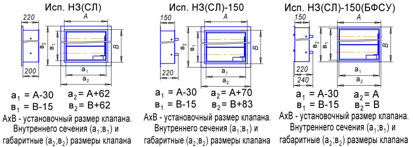
Рис.1. Установочные, габаритные и размеры внутреннего сечения клапана.
